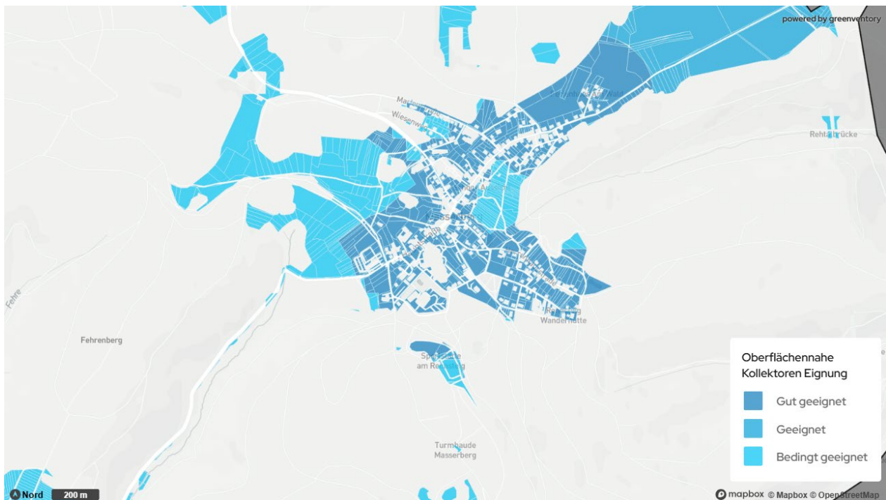
Abbildung 4-28: Eignungsgebiete für Erdwärme-Sonden – Masserberg
