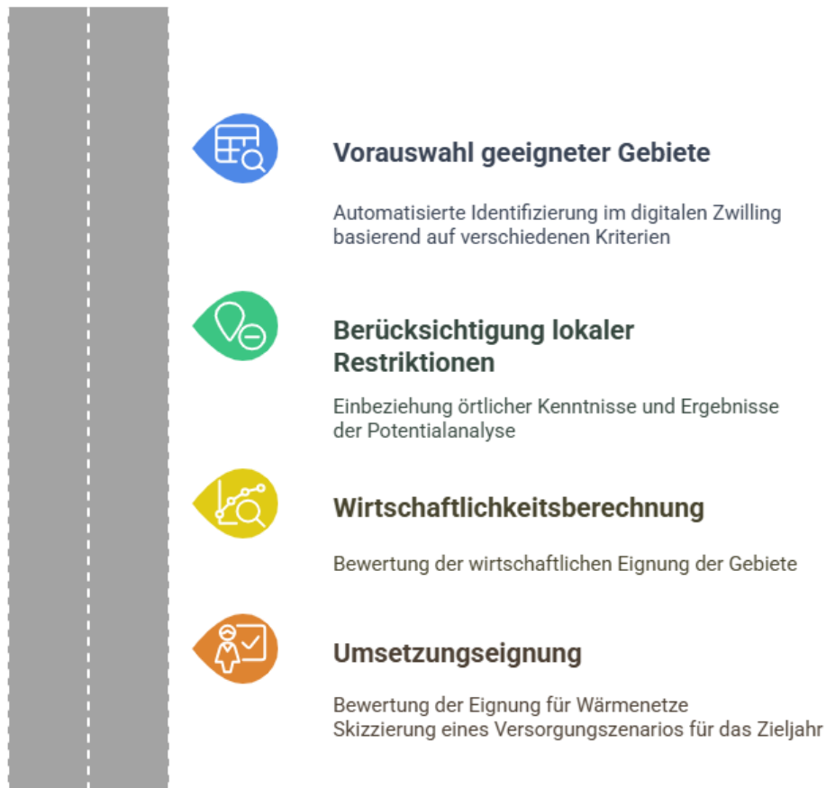
Abbildung 5-2: Prozess zur Erarbeitung der Untersuchungsgebiete zur zentralen Wärmeversorgung
